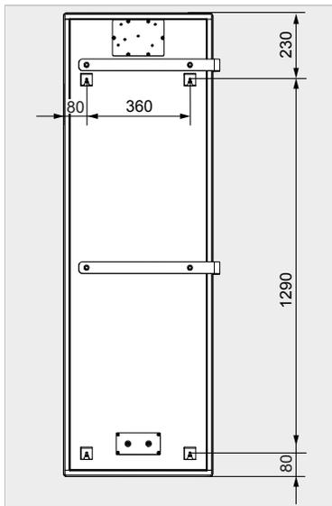
Für die Montage auf Beton, Vollstein, Backstein, Kalksandstein, Porenbeton, Plattenbaustoffe:
