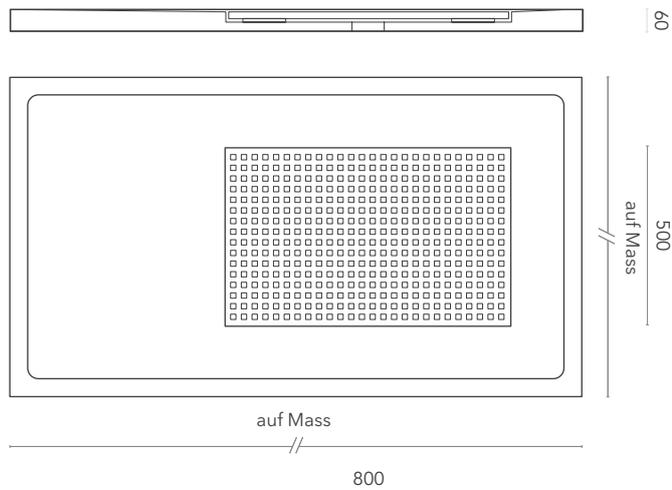
Duschtasse Modell Grid 2 aus Corian®, mit thermogeformter Wanne und abnehmbarer Abdeckung in Teak. Bohrung für Ablaufgarnitur Ø 90 mm. Flächenbündiger Einbau möglich. Auf Anfrage Ablaufgarnitur erhältlich und /oder Einfräsung für Glaswand. Länge und Tiefe der Duschtasse individuell anpassbar.
